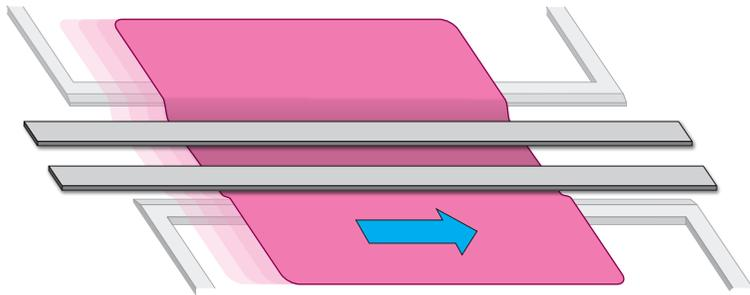
2. Erster Faltvorgang, der von dem linken Schwert ausgeführt wird.
