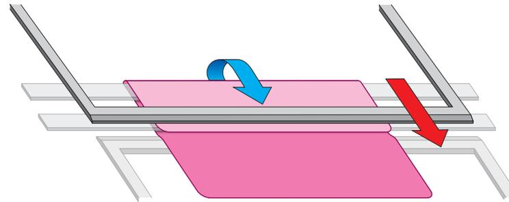
3. Zweiter Faltvorgang, der von dem rechten Schwert ausgeführt wird. Dies wird erreicht gleichzeitig mit der Einfahrbewegung des linken Schwerterns.
