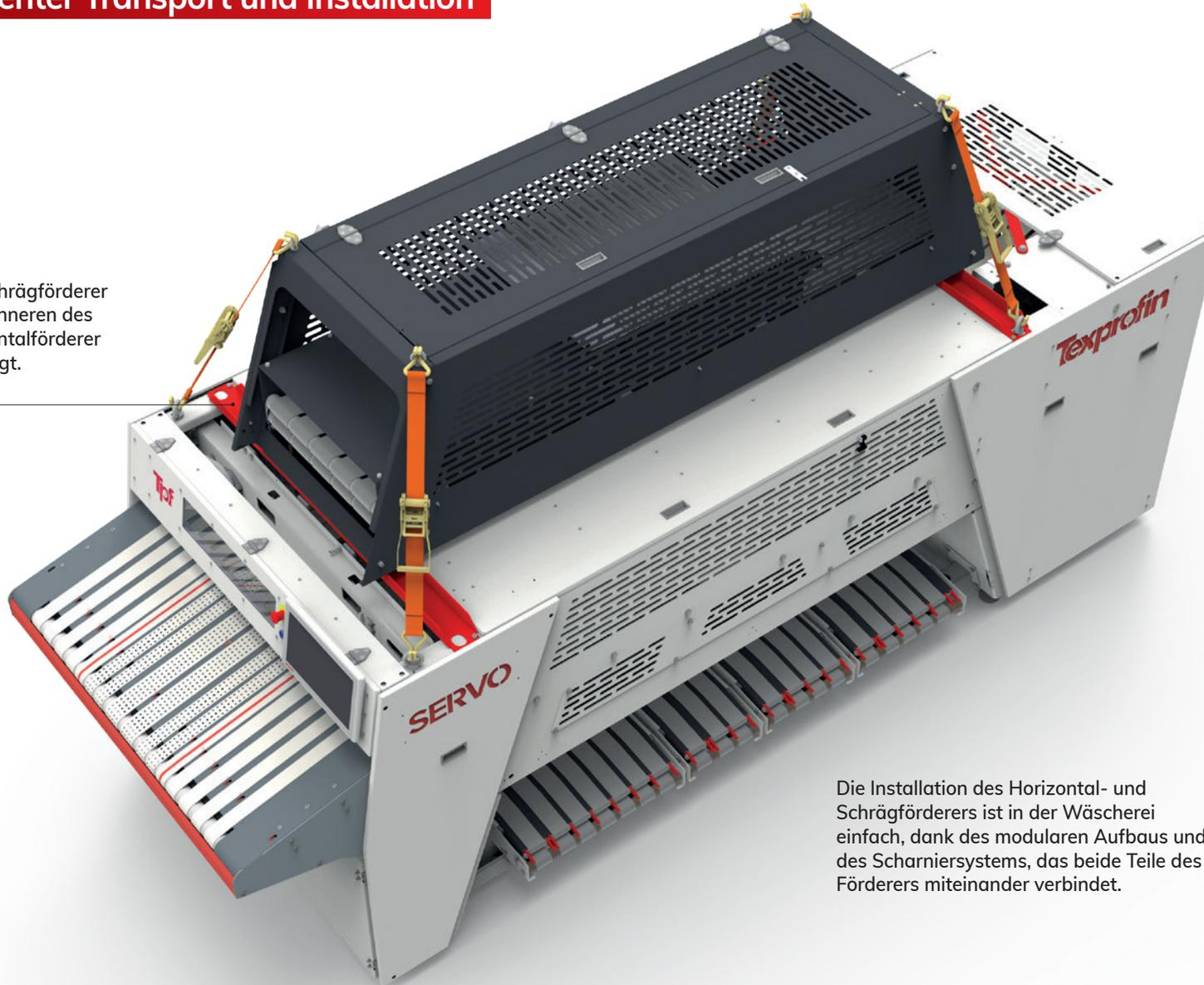
Die Installation des Horizontal- und Schrägförderers ist in der Wäscherei einfach, dank des modularen Aufbaus und des Scharniersystems, das beide Teile des Förderers miteinander verbindet.
